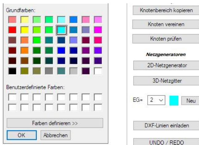
Wählen Sie wieder Menü „3D-Netzgitter“ um das zweite Netzgitter zu generieren. Geben Sie die Kanten 2,3,4 und 5 sowie die Anzahl in X-Richtung = 3 und in Y-Richtung = 50 ein um ein Netzgitter mit Menü „3D-Netzgitter generieren“ zu erzeugen.
