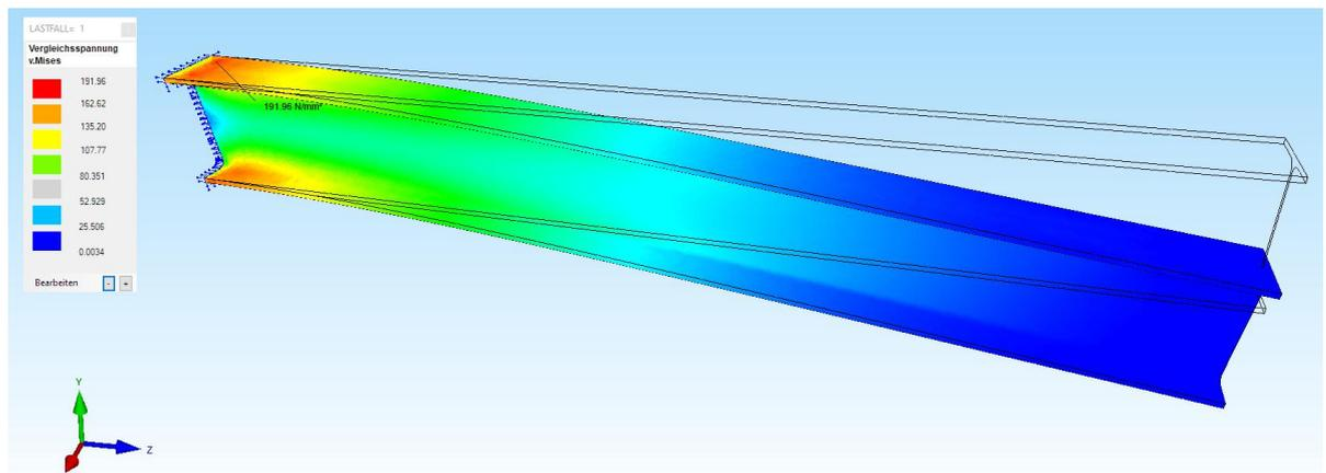
**Maximale Zug-Hauptspannung S1 = 203.54 N/mm<sup>2</sup>**
