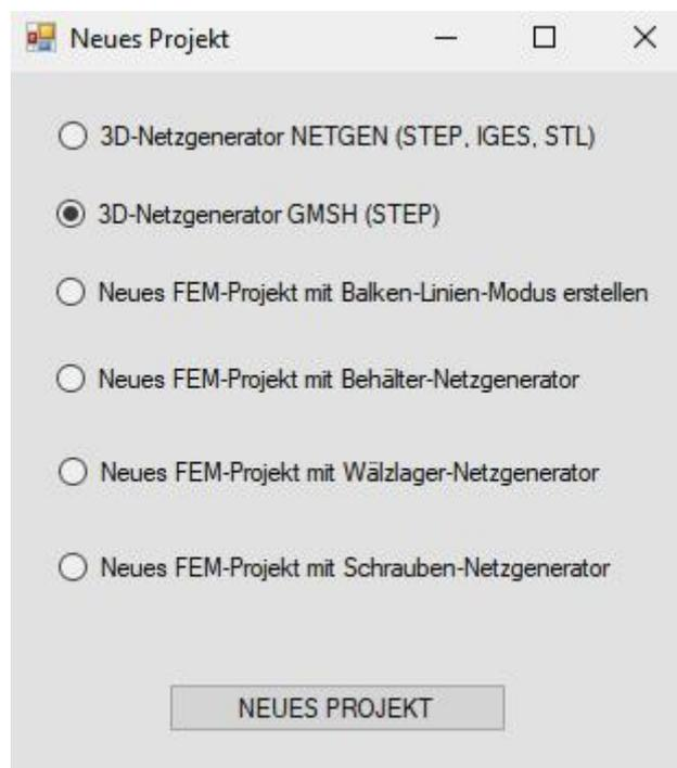
Wählen Sie in GMSH das Menü „3D“ sowie zweimal nacheinander Menü „Refine by splitting“ um ein FEM-Netz mit 46 272 TET4-Elementen und 9 975 Knotenpunkten zu generieren.
