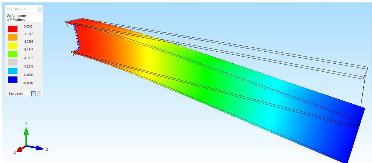
**Max. v.Mises-Vergleichsspannung = 191 N/mm<sup>2</sup> (exakt = 204 N/mm<sup>2</sup>)**
