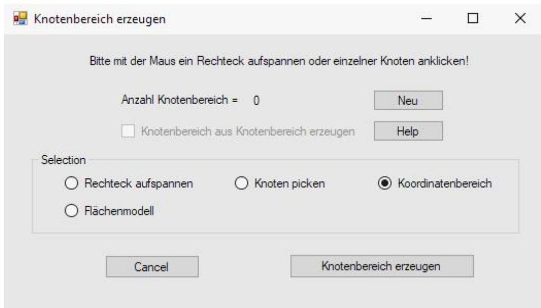
neuen Knotenbereich von Z= 500 mm bis Z=1800 mm mit einer kleinen Toleranz wegen den unstrukturierten Knotenpunkten.
