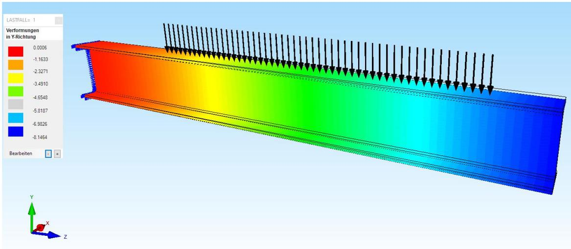
**Max. v.Mises-Vergleichsspannung = 200.4 N/mm<sup>2</sup> (exakt = 204 N/mm<sup>2</sup>)**
